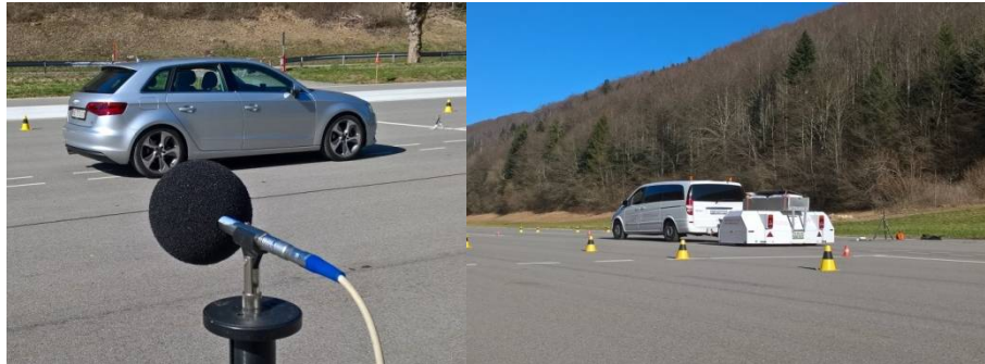
Abbildung 4: Coast-by Messung der Continental ContiSportContact 225/55 R16 Reifen am Audi A3 SB 2.0 TDI (links) und dieselben Reifen am adaptierten CPX-Messanhänger montiert mit gemessen unter Last nach UN/ECE R117 (Wirtschaftskommission der Vereinten Nationen für Europa (UN/ECE) 2011) auf dem Testgelände DTC in Vauffelin.
