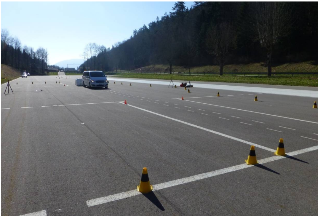
Abbildung 18: Coast-by und CPX-Messungen auf dem normierten Testbelag des Testgeländes DTC in Vauffelin.
