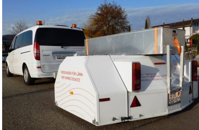
Abbildung 3: Adaptiertes CPX Messsystem von Grolimund + Partner AG. Mit der Befestigung auf dem Anhänger wurde das Gewicht am jeweiligen Reifen angepasst um sie bei relativ zum Load-Index identischer Belastung (75% gemäss UN/ECE Reg. 117) zu messen.
